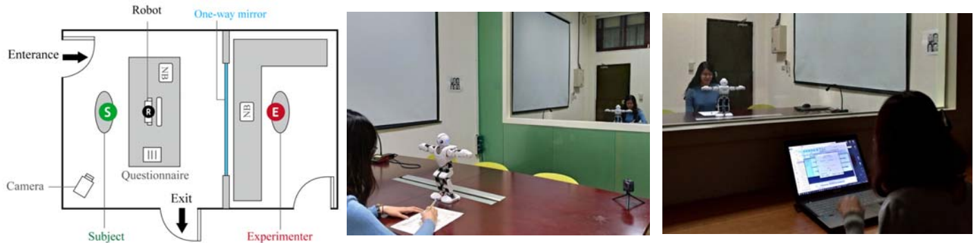
圖 5. Wizard of Oz 實驗配置 (左)，實驗室與觀察室由單面鏡隔開。受測者角度之實驗室(中)，鏡後之觀察室(右)。
